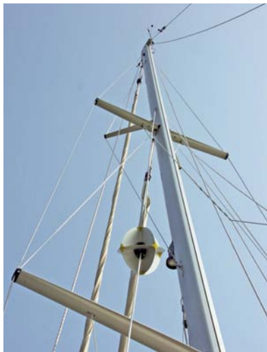
Das Kutterrigg ist äußerst solide ausgeführt und sicher verstagt – Furlex-Rollanlagen und Dyneema-Fallen gehören zur Standardausstattung.
