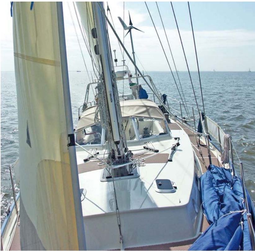
Die Wantenpüttinge münden mittig auf dem Seitendeck – dennoch kommt man gut daran vorbei. Auch bei schwerem Wetter bewegt man sich sehr sicher an Deck – nur das Aufbaudach bietet zu wenig Halt.
